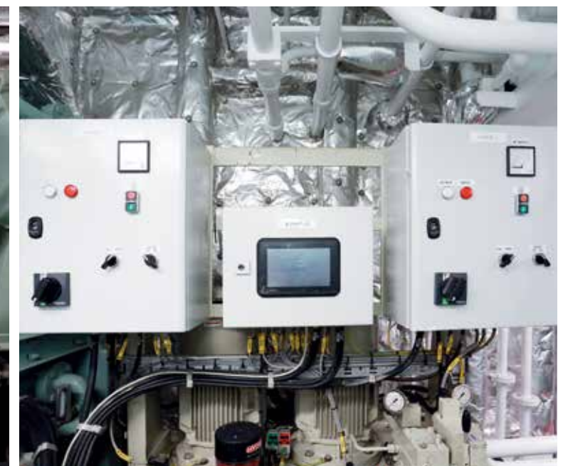
▲ 가변피치 프로펠러 유압장치 C.P.P Hydraulic Power Pack
