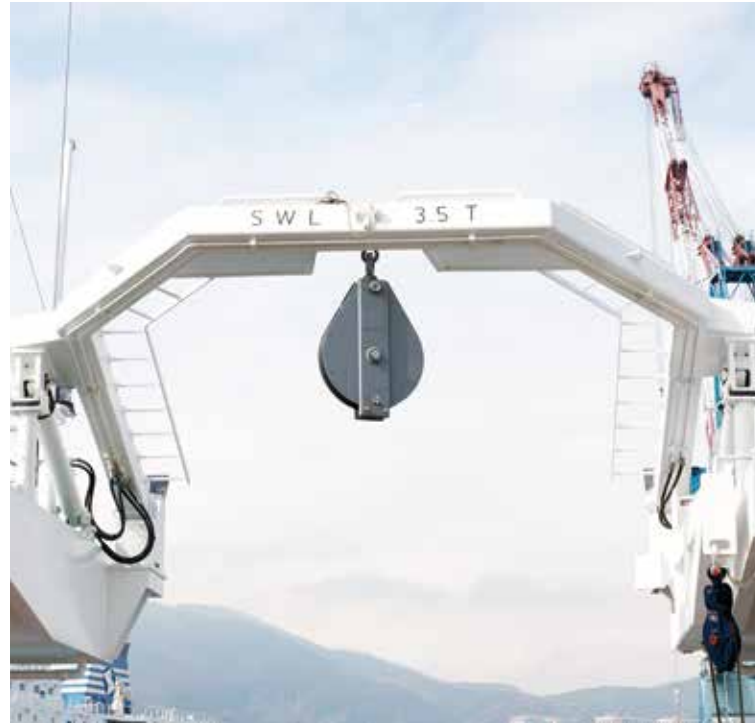
▲ 선미 A 프레임 Stern A-Frame (3.5 ton)
