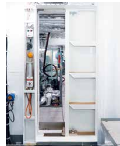
▲ 수밀문 및 수밀 안전제어 콘솔 Water Tight Sliding Door &amp; Safety Control Console
