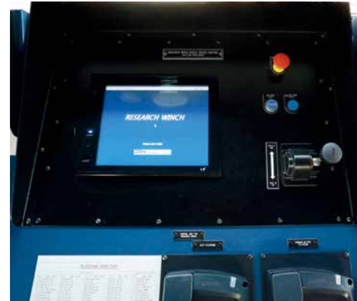
▲ 연구용 윈치 컨트롤러 Research Winch Controller
