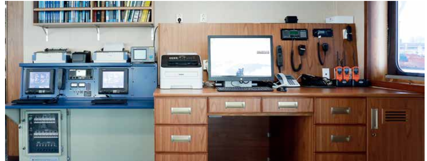
▲ 전세계해상조난안전시스템 / 무선장치 GMDSS / Radio Console
