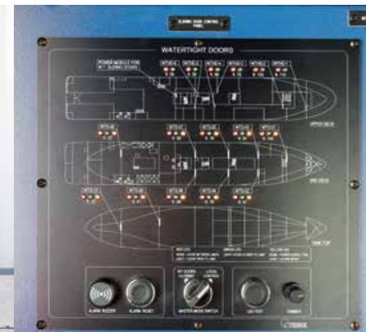
▲ 수밀문 및 수밀 안전제어 콘솔 Water Tight Sliding Door &amp; Safety Control Console
