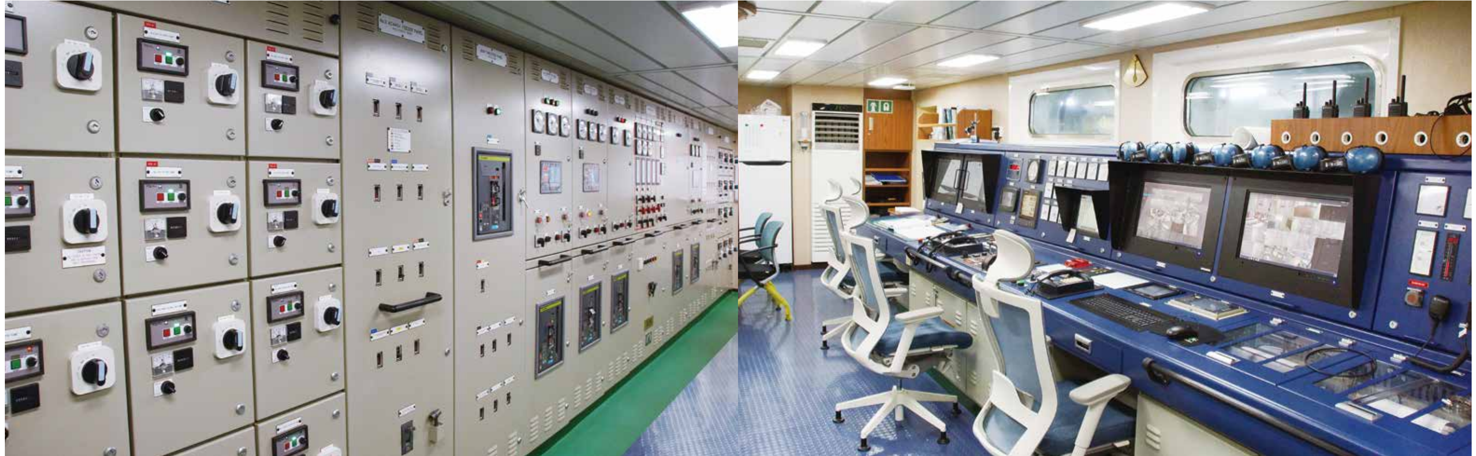
▲ 주 배전반 및 기관 조종 콘솔 MSBD & Engine Control Console
