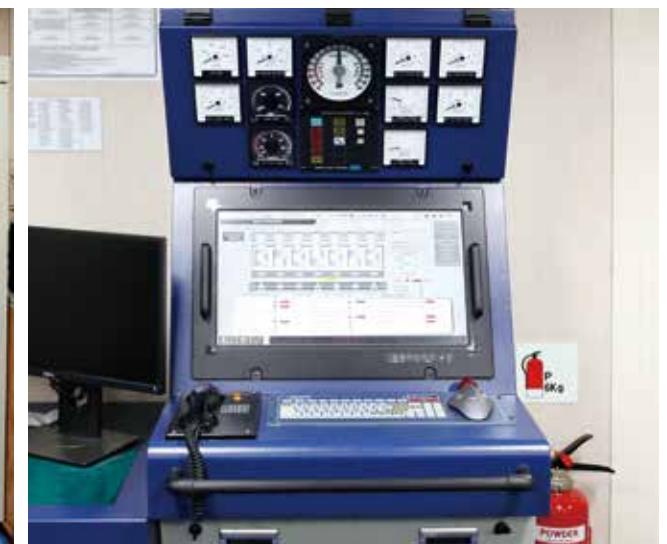
▲ 기관 종합제어 및 감시장치 실습 콘솔 ICMS Training Console
