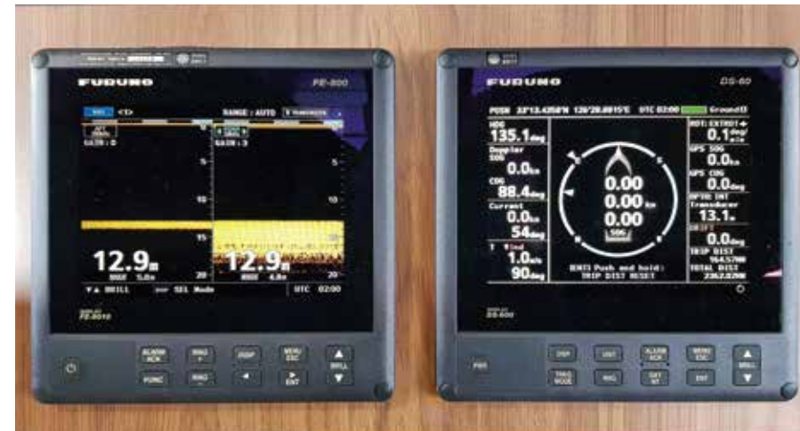
▲ 측심기 및 선속계 ECHO Sounder & Speed log Unit
