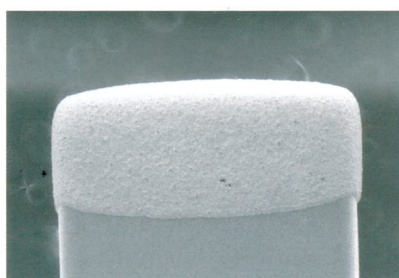
MLCC Chip 도금 SEM 사진
