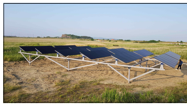
(d) 새만금 태양광 지지구조물 실증화 시험단지 상세사진 (연약지반 지지구조체 파일 기초실험)
